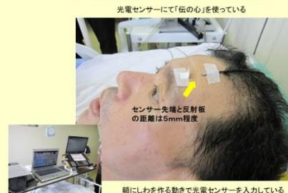
左は、自由にする考え方、右は規制する考え方で、光電センサーを入力装置として使えるようにしています。左は、腕の重さの負担を緩和するために右腕下に枕を入れました。右手の平と親指の間に隙間を作ることで、親指の動きを可能にしています。親指の動きに合わせて、光電センサーを設置しています。右側は、額のしわを作る動きを利用して、光電センサーと反射板の動きを規制することでスイッチ入力を可能にしました。
