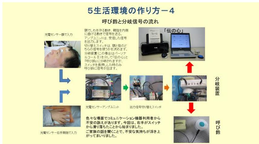
分岐装置は、コミュニケーション機器と呼び鈴を一つのスイッチで使うための装置です。それを、不安解消のために押しても、ナースコールにつながらないように使い方にルールを導入してみました。一方で、二つのスイッチを好きな時に使うことが出来れば疲れないという訴えがあり、考案したのが右の写真です。額と手指の動きを光電センサーで拾い、分岐装置に信号を流しました。この時は、切り替えスイッチを使いましたが、今は使っていません。
